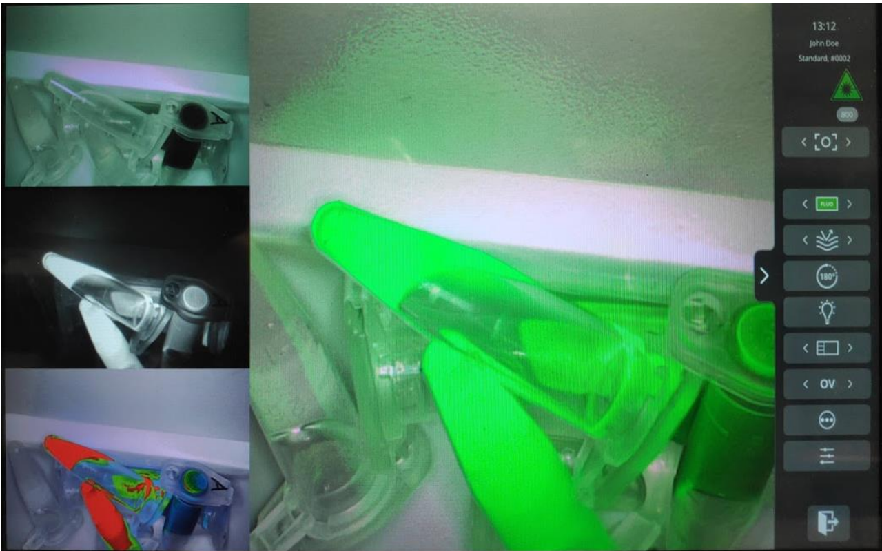
Rysunek 10: Widok trybu Chirurgia (ICG). Główny obraz odpowiada trybowi Overlay (OV). Po lewej, od góry do dołu: tryby RGB, NIR, GR.
