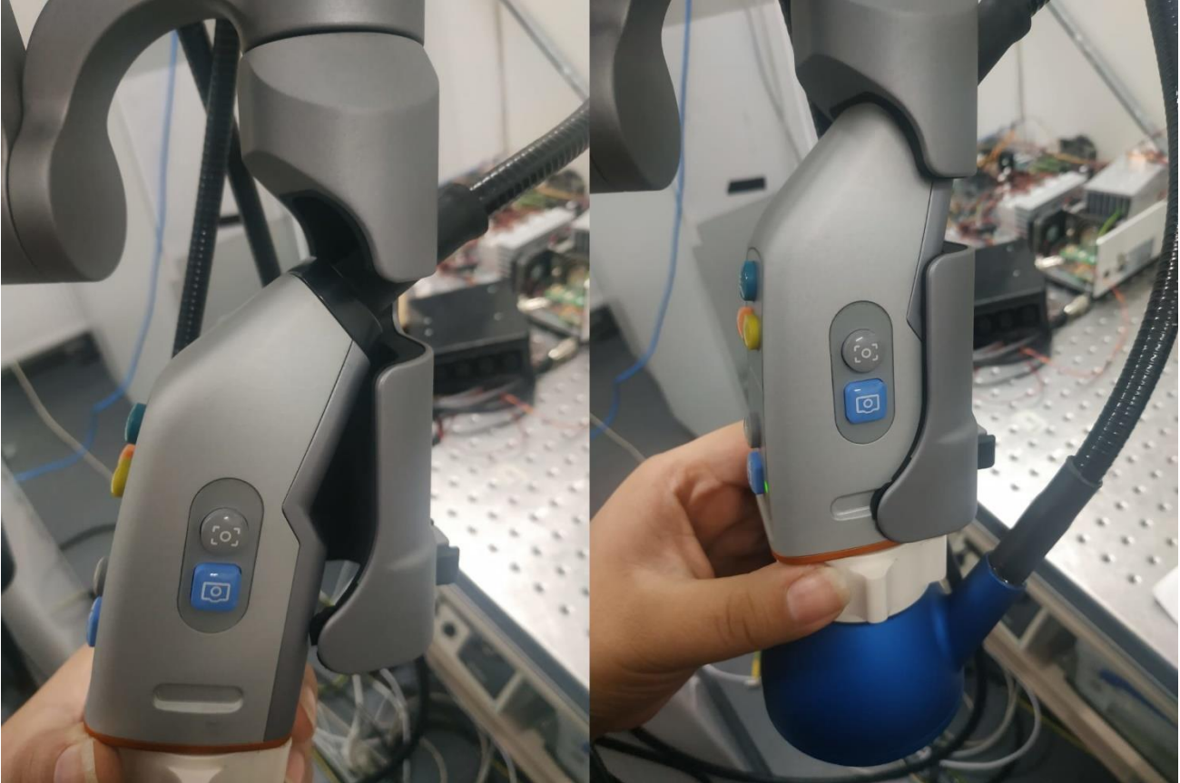
Rysunek 14: Kamera umieszczona w chwytaku ramienia
