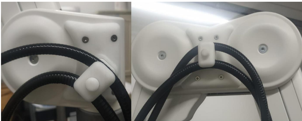
Figuur 15: Kabels vastgezet in camera-arm
