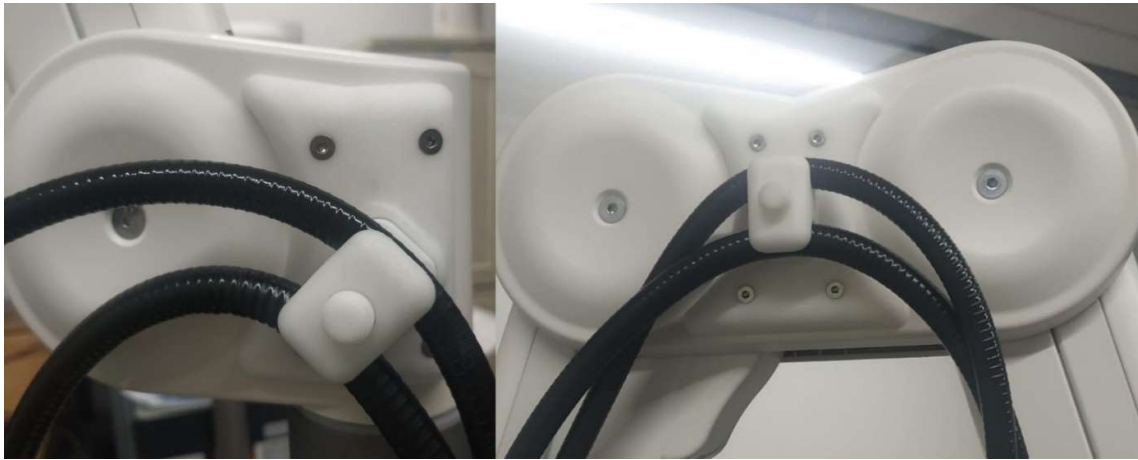
Figuur 15: Kabels vastgezet in camera-arm
