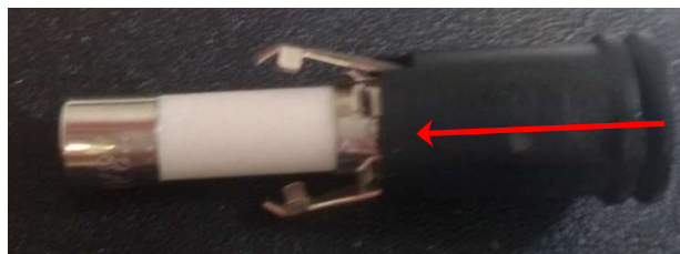
Figuur 23: De zekering uit de houder trekken
