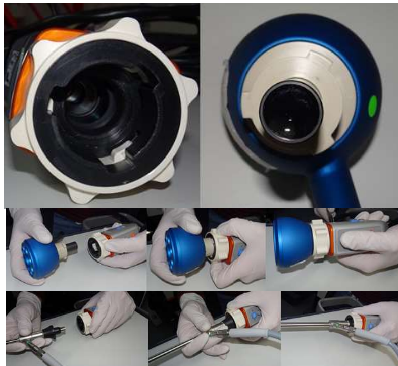
Figuur 4 Het ringlicht / laparoscoop verbinden met de camera
