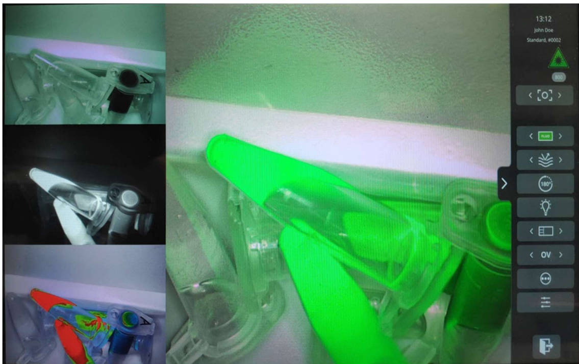
Figuur 10: Weergave operatiemodus (ICG). Hoofdafbeelding komt overeen met Overlay (OV)-modus. Aan de linkerkant, van boven naar beneden: RGB, NIR, GR-modi.
