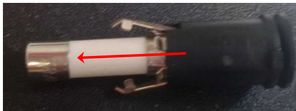
Figuur 19 De zekering uit de houder trekken
