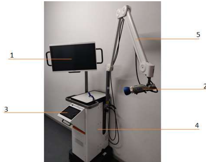
Figuur 1 Overzicht van de QUEST SPECTRUM® 3. 1) 4K Monitor, 2) Sensitieve camera, 3) Interactieve touchpad, 4) Trolley, 5) Mechanische arm
