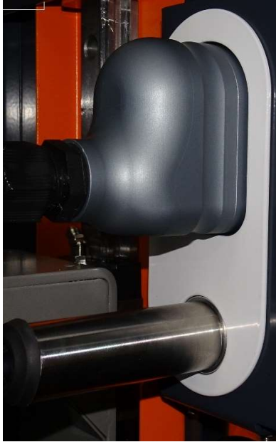
Figuur 3 Camera- and lichtkabel aansluiting
