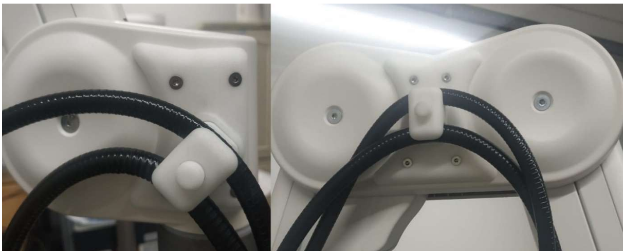
Figuur 15: Kabels vastgezet in camera-arm
