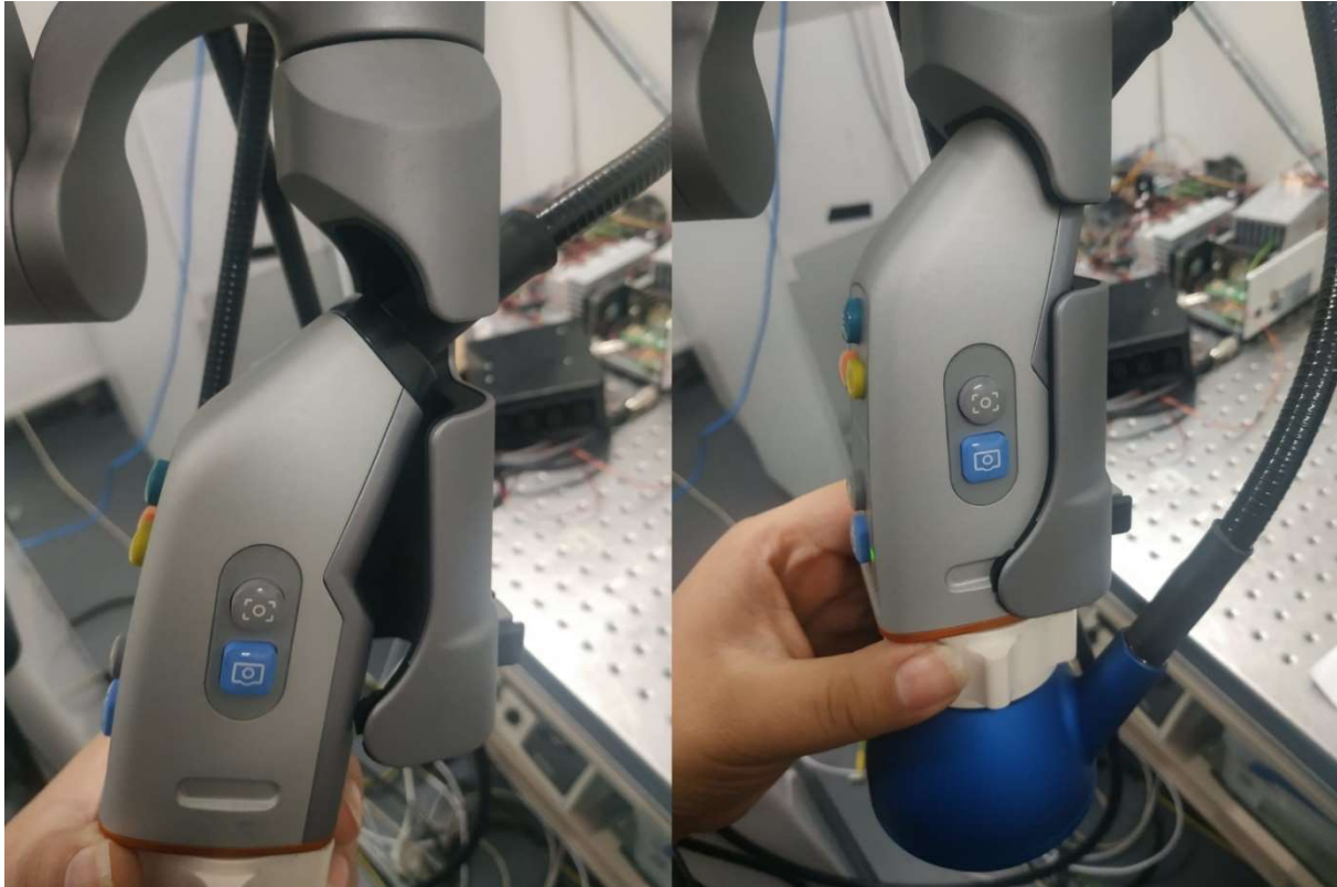
Figuur 14: Camera gepositioneerd in armgrijper
