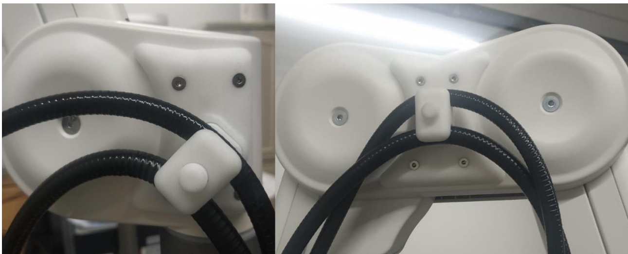
Figura 15: Cavi fissati nel braccio della telecamera
