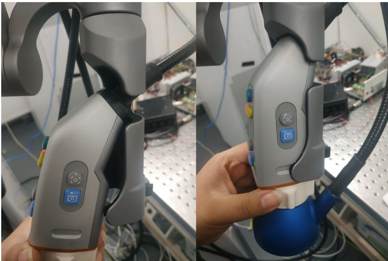
Figura 14: Telecamera posizionata nella pinza del braccio
