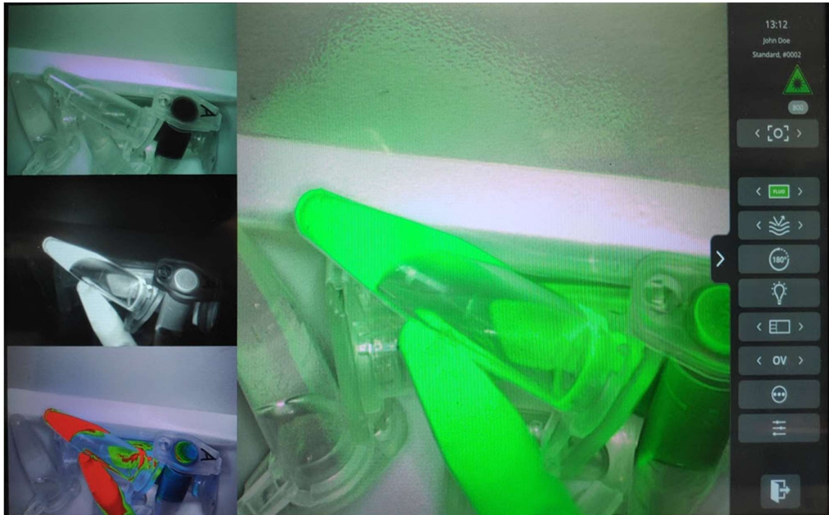
Figure 10 : Vue en mode Chirurgie (ICG). L'image principale correspond au mode Overlay (OV). A gauche, de haut en bas : modes RVB, NIR, GR.
