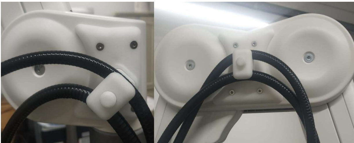
Figure 15 : Câbles fixés dans le bras de la caméra
