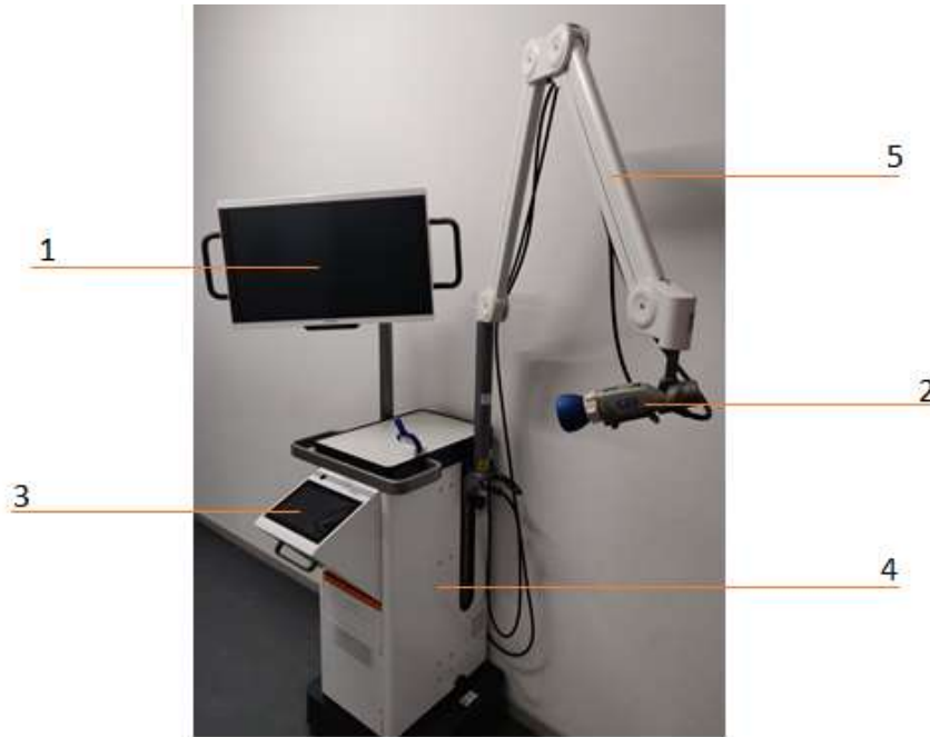
Figure 1: d'ensemble du QUEST SPECTRUM® 3. 1) Moniteur 4K, 2) Caméra sensible, 3) Pavé tactile interactif, 4) Chariot, 5) Bras de caméra mécanique
