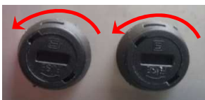
Figure 22: Remplacement des fusibles
