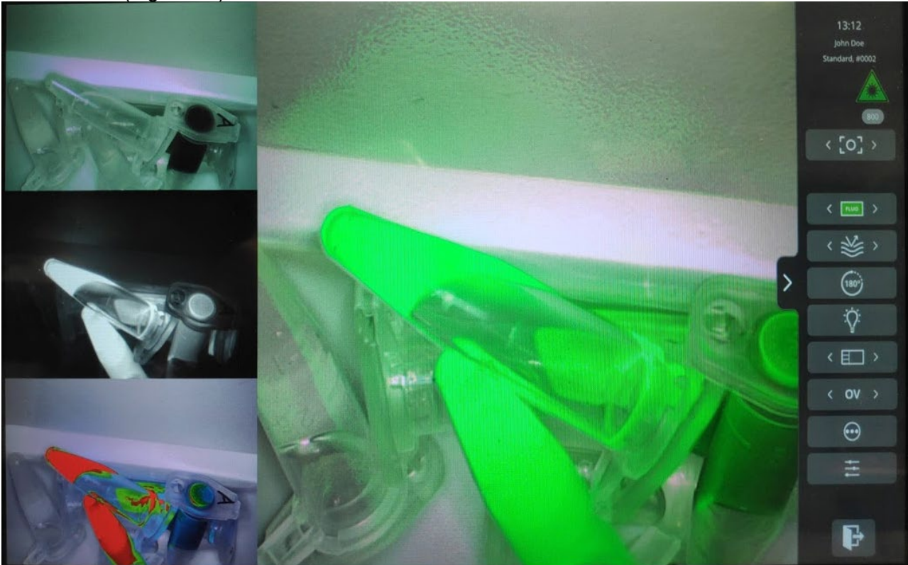
Figure 10 : Vue en mode Chirurgie (ICG). L'image principale correspond au mode Overlay (OV). A gauche, de haut en bas : modes RVB, NIR, GR.
