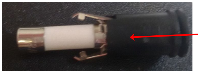
Figura 23: Extraiga el fusible
