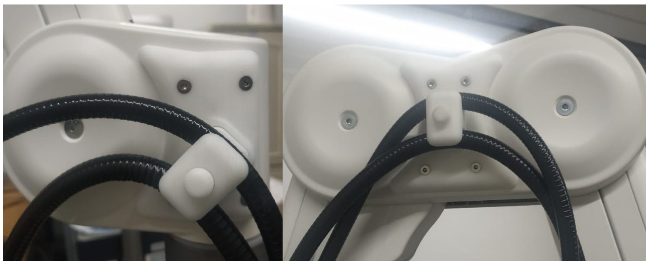
Figura 15: Cables asegurados en el brazo para cámara
