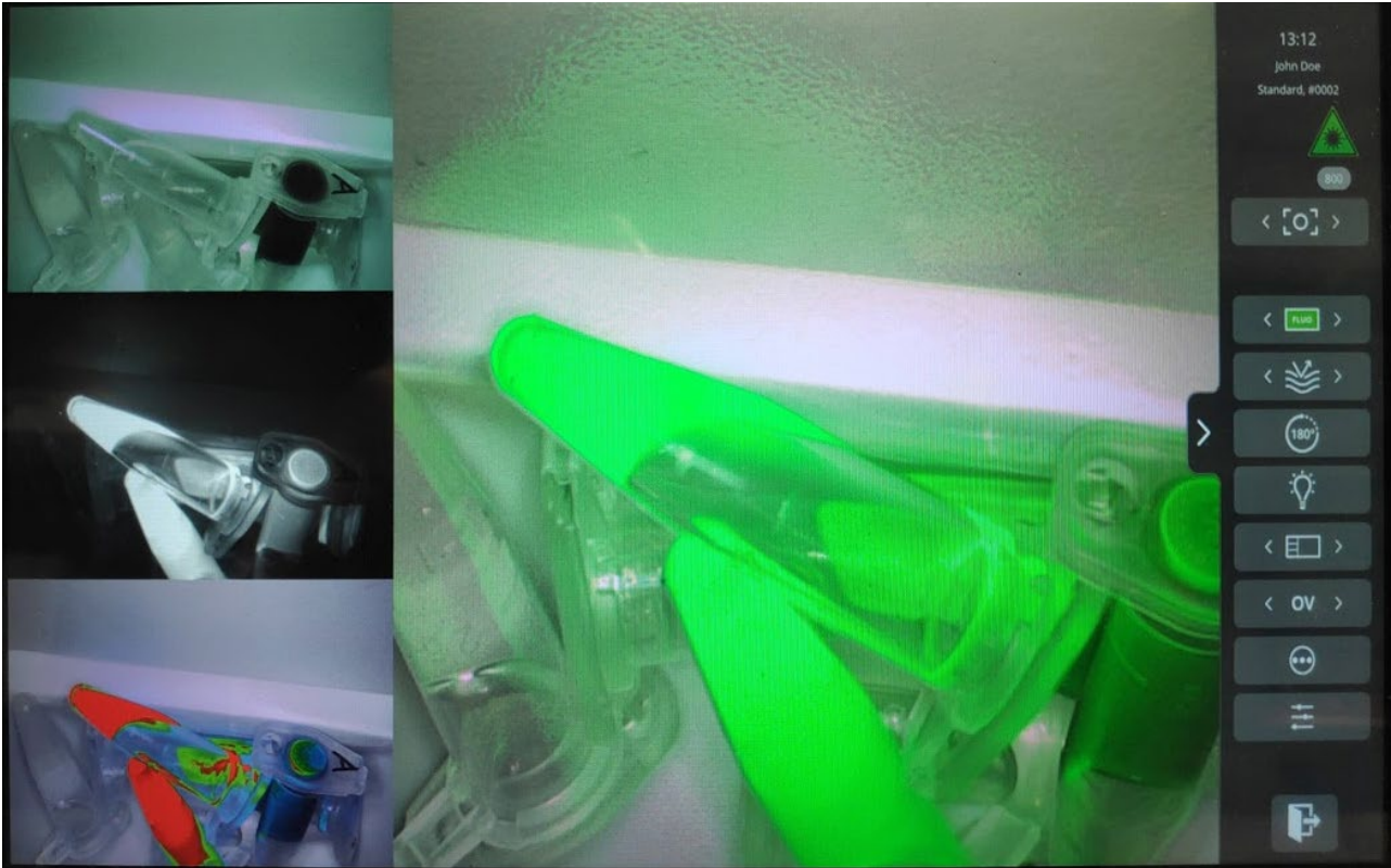
Figura 10: Vista del modo de cirugía (ICG). La imagen principal corresponde al modo Superposición (OV). A la izquierda, de arriba a abajo: modos RGB, NIR, GR.
