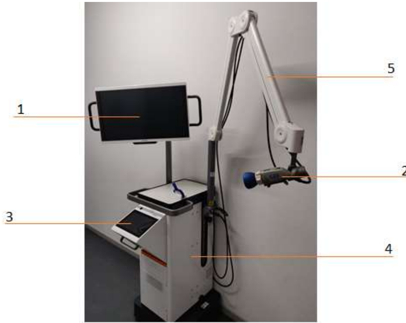
Abbildung 1: Übersicht über das QUEST SPECTRUM® 3. 1) 4K-Monitor, 2) empfindliche Kamera, 3) interaktives Touchpad, 4) Wagen, 5) mechanischer Kameraarm
