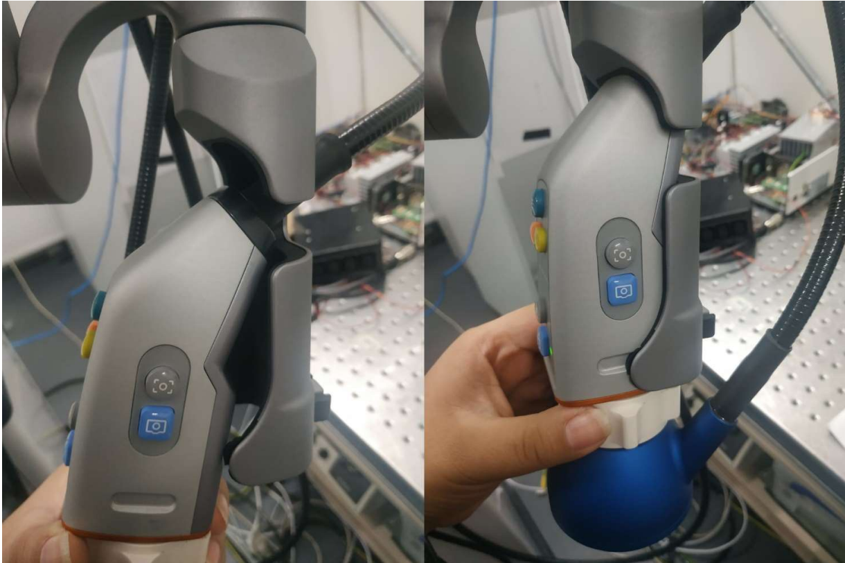
Abbildung 14: Kamera im Armgreifer positioniert
