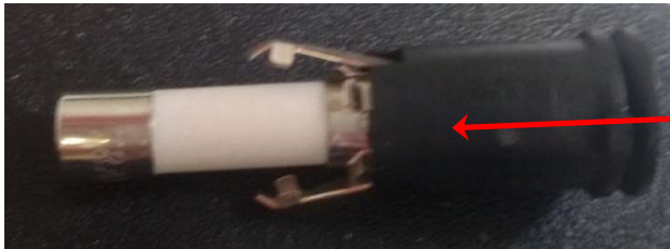
Abbildung 23 Herausziehen der Sicherung
