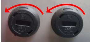
Abbildung 22: Ersetzen von Sicherungen
