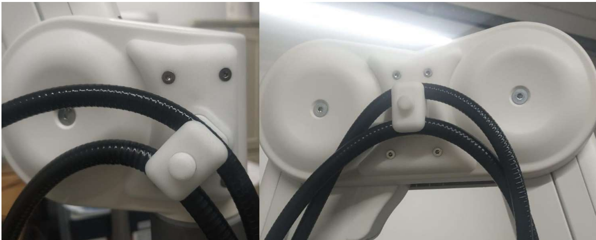
Abbildung 15: Kabel im Kameraarm befestigt
