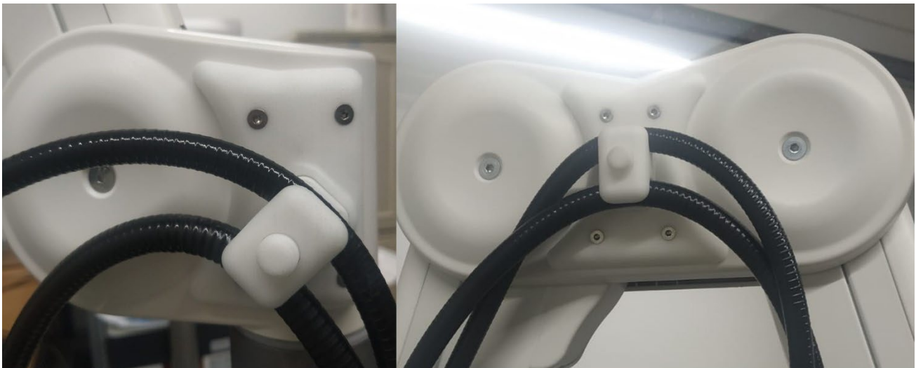
Abbildung 15: Kabel im Kameraarm befestigt
