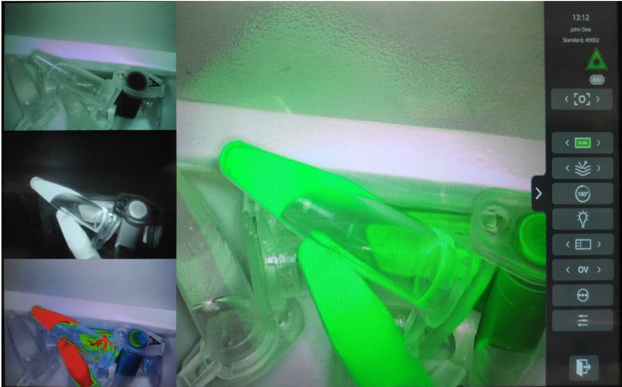
Abbildung 10: Ansicht des Operationsmodus (ICG). Das Hauptbild entspricht dem Overlay (OV)-Modus. Links von oben nach unten: RGB, NIR-, GR-Modi.
