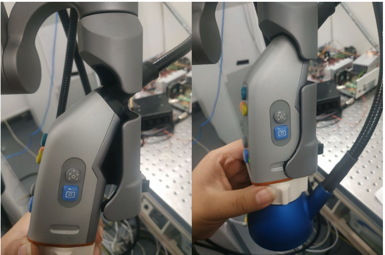
Abbildung 14: Kamera im Armgreifer positioniert
