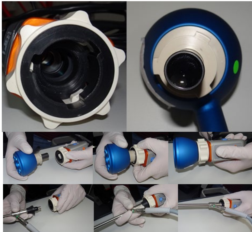
Abbildung 4: Ringlicht oder Laparoskop an die Kamera anschließen
