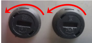
Abbildung 22: Ersetzen von Sicherungen
